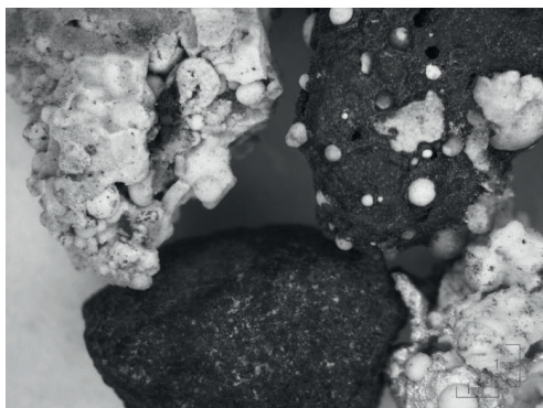
Рисунок 2. Комковидные агрегаты минеральных фаз различного состава в крупной фракции смета глинозема
